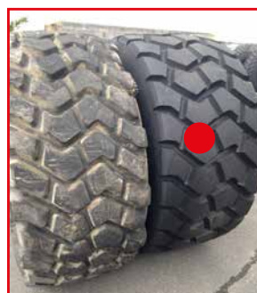
Le pneu a été fabriqué pour faire la paire avec un pneu neuf que le client avait tout seul dans son stock, ne pouvant faire une paire car modèle plus fabriqué.
