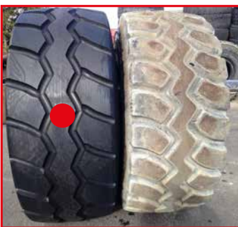
Celui en photo à une profondeur de 4cm, il a été fabriqué pour le marier avec un rechapé ldd1 de cette hauteur.
